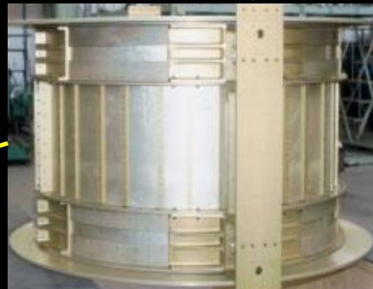
反符合计数器 (ACC) 排除侧面入射粒子
