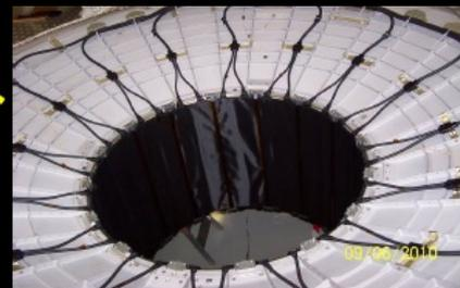
下层飞行时间探测器 (LTOF) : 测量电荷、速度
