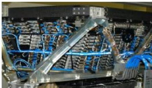
穿越辐射探测器(TRD) 识别 e^+, e^-
