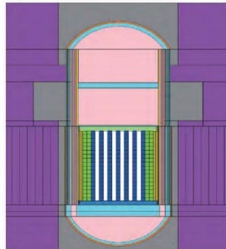
核电厂一次屏蔽主管道出口处中子屏蔽计算模型
