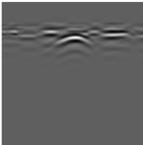
应用 Fourier 频域滤波器后，大部分横向条带被消除
